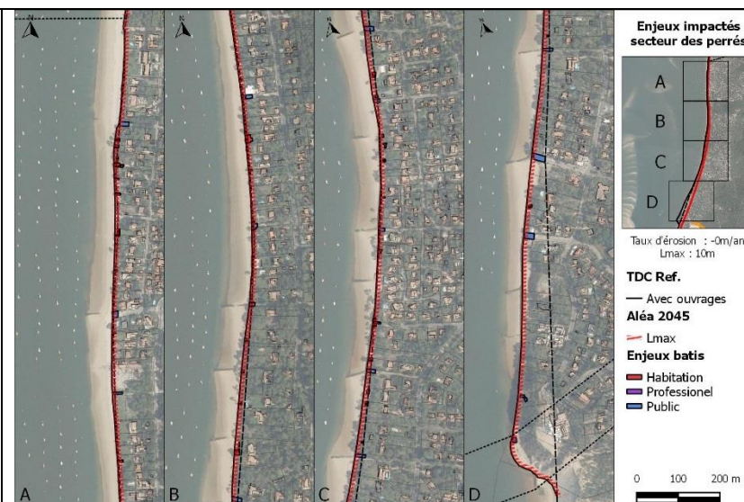
Figure 5 : Projection de l'érosion à 2045 pour le scénario 3A du secteur des Perrés
