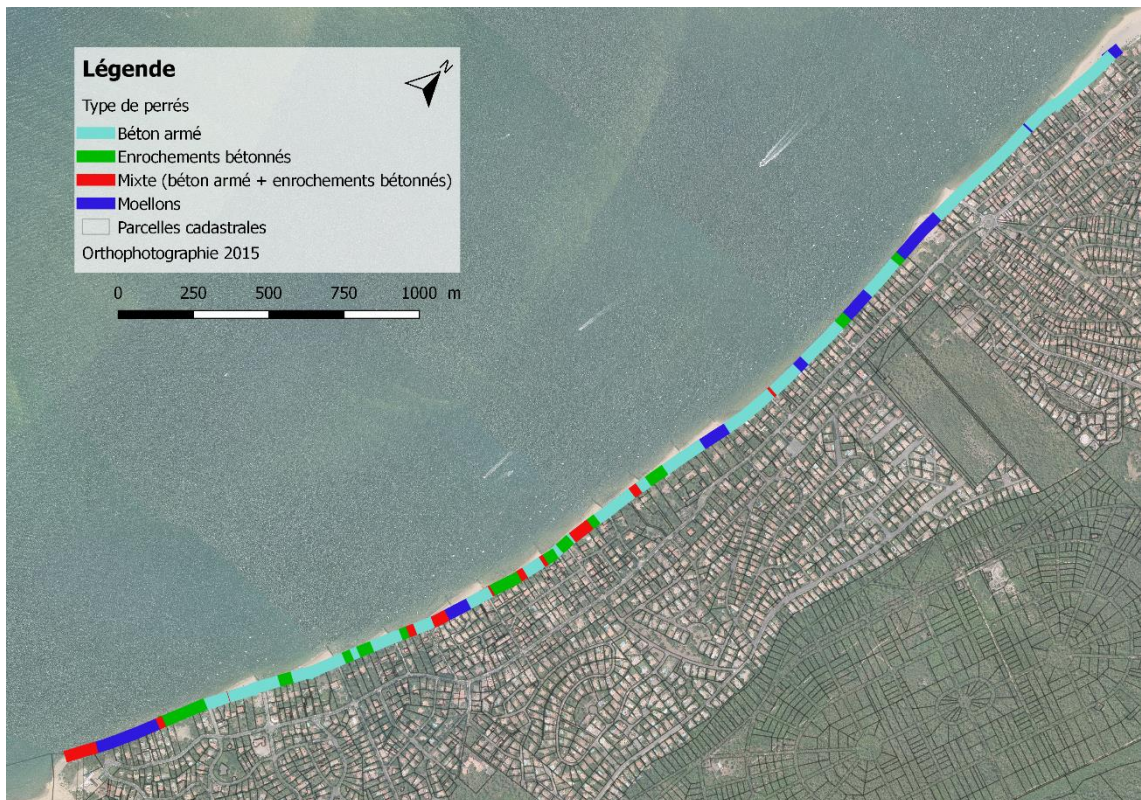
Figure 62. Typologie des perrés.
