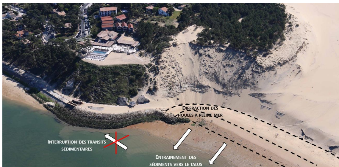
Figure 27 : Schéma du fonctionnement hydrosédimentaire au niveau du musoir de la Corniche.
