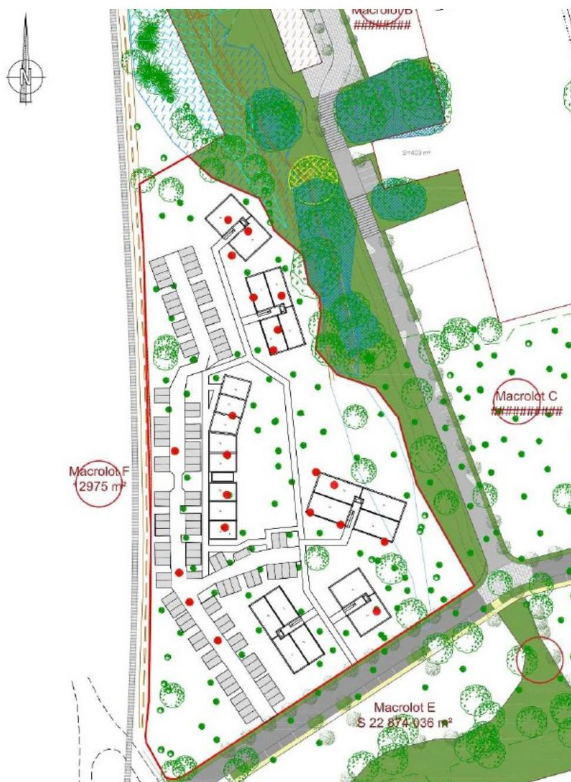
Figure 12 : Plan d'abattage des arbres au sein des logements privés (macrolot 5)
