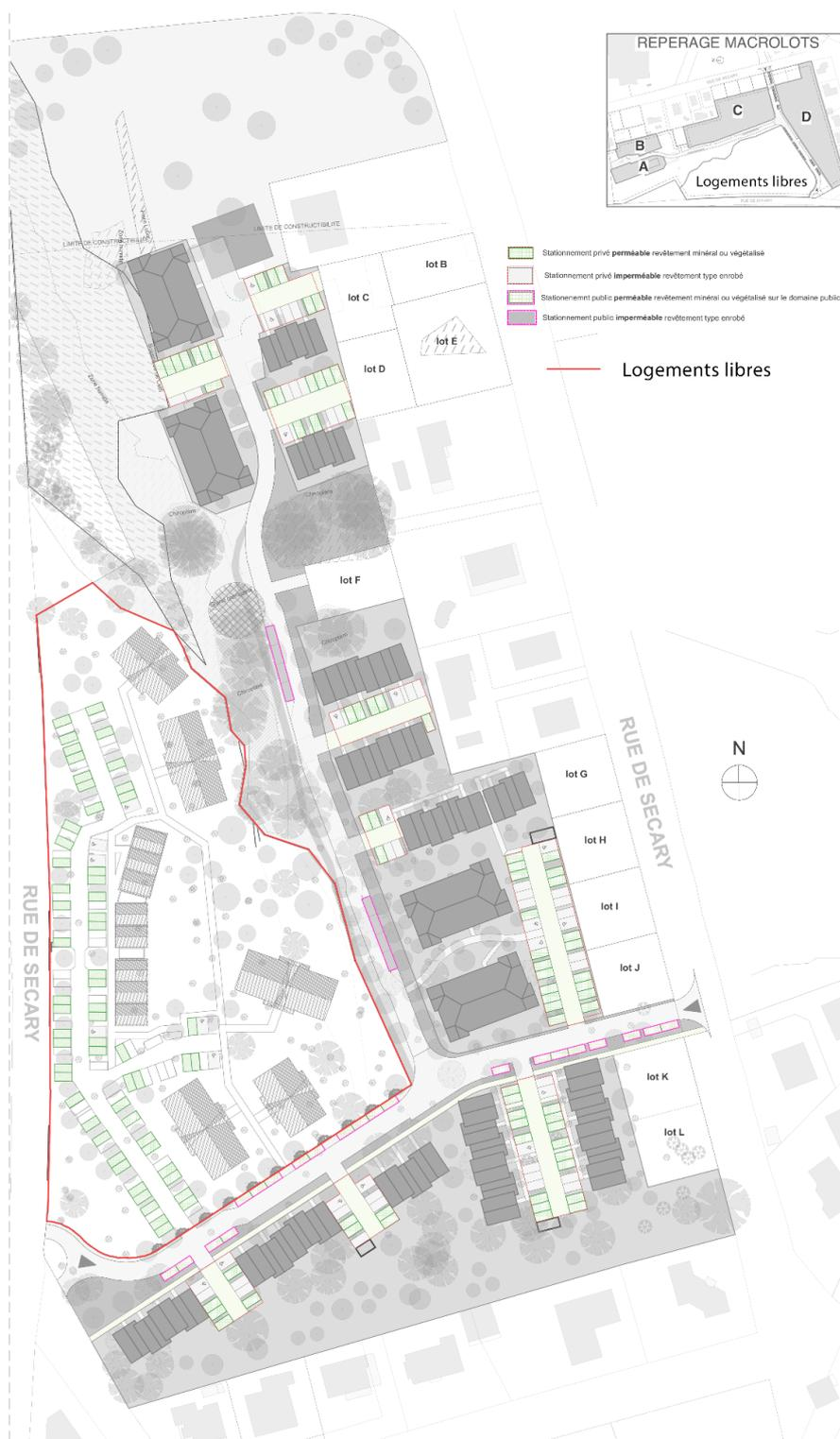
Figure 13 : Plan d'implantation des places de stationnement
