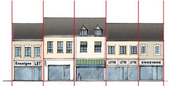
✓ **IV.2.1.8** : L'enseigne murale, réalisée en lettres découpées ou bandeau, **positionnée horizontalement** sur la façade commerciale doit être installée en considérant les ouvertures existantes :
