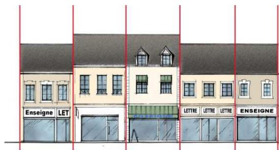
✓ **IV.3.1.7** : L'enseigne murale, réalisée en lettres découpées ou bandeau, **positionnée horizontalement** sur la façade commerciale doit être installée en considérant les ouvertures existantes :
