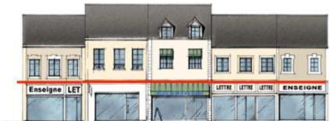
✓ **IV.3.1.3** : L'enseigne murale doit être inscrite dans les limites du rez-de-chaussée sans dépasser le bandeau ou la corniche si elle existe, ou le cas échéant l'appui de fenêtre du 1<sup>er</sup> étage.
